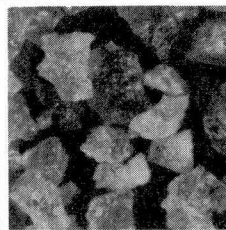
写真-1. 海砂(×45) 写真-2. スラグA(×45)
