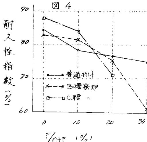
ライアッシュを混入しても、普通ポルトランドセメントにフライアッシュを混入した場合と同様の傾向を示している。凍結融解に対する耐久性を必要とする場所に、フライアッシュを混入した高炉セメントを用いる場合は、ポルトランドセメントにフライアッシュを用いる場合と同様に、フライアッシュの混入量は20%を限度とした方がよい。
