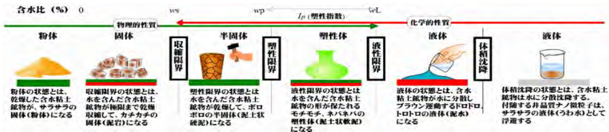
図-3 スメクタイトなどの層状珪酸塩粘土鉱物のコンシステンシー限界
