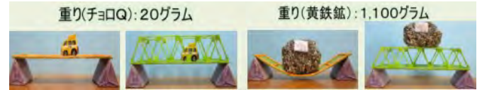
写真-2 けた橋とトラス橋(荷重载荷)
