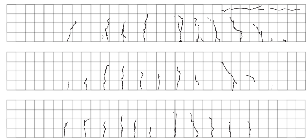
図3 各供試体のひび割れ(順に G-B-1 B面, G-B-2 B面, C-B A面)
