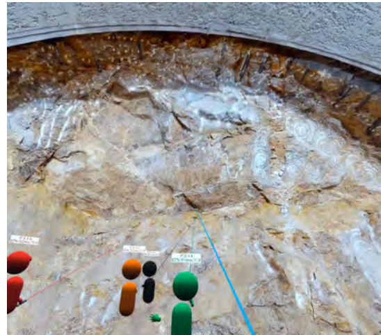
図-7 VRデータ構築したトンネル切羽周辺のVR空間
