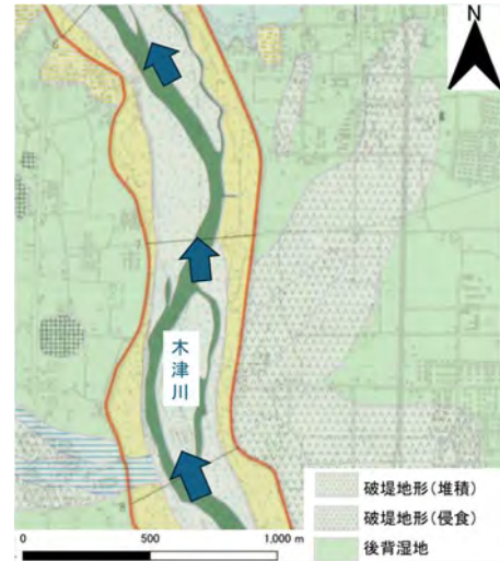
図1 淀川三川合流点から7km付近の木津川下流域に関する水害地形分類図
