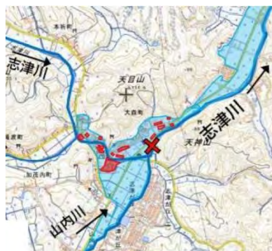
図-2 浸水範囲(×は堤防決壊地点、赤色は床下、床上浸水) 1)
