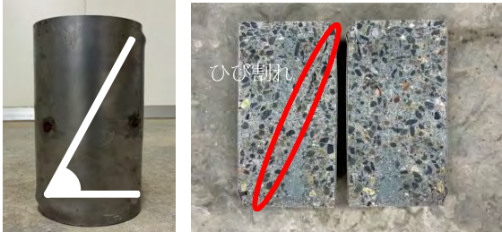
写真-1 S-AAM-50-2 の破壊性状
