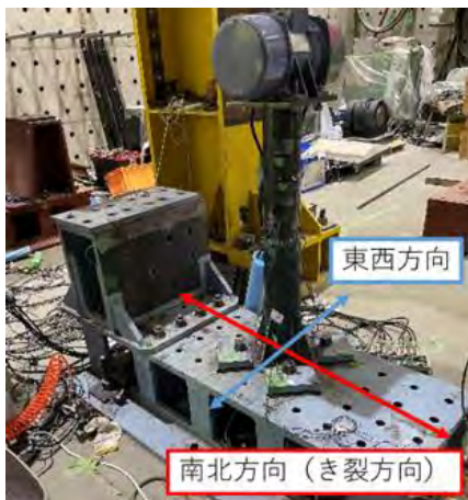
図-1 加振機を取り付けた試験体
