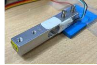
ロードセル : 荷重（力）を電圧として出力
