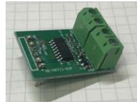
ADコンバータモジュール : 微小な電圧をアンプにより増幅させ、アナログ情報をデジタルでコンピュータが読み取れる情報に変換し記録
