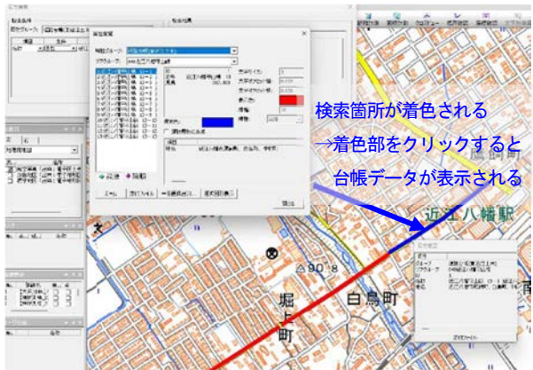
図-2 Survey Viewによる地図上での道路台帳検索
