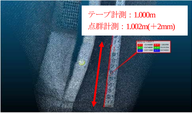
図-3 計測精度の検証（リボンテープ延長との比較）
