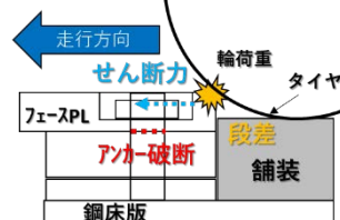
図-2 フェースプレート破断原因の推定
