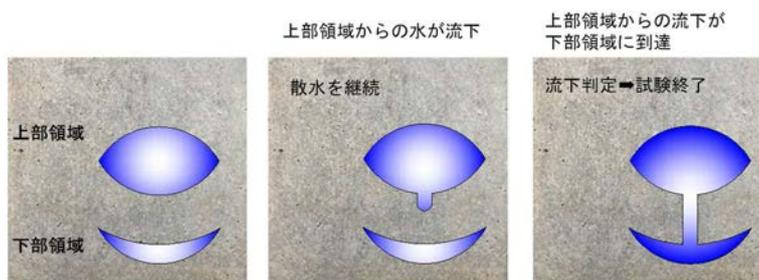
図1 散水試験の概要
