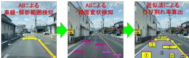
図-2 ひび割れ評価の原理
