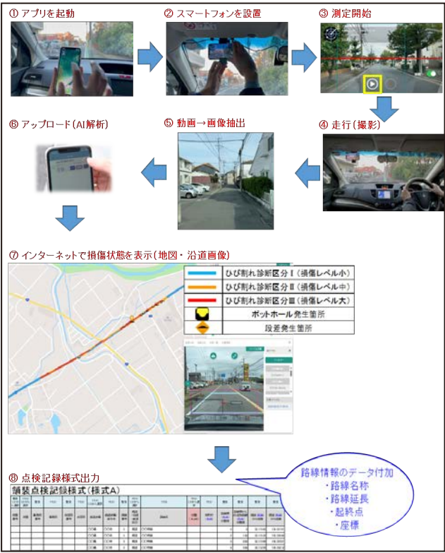
図-7 舗装点検手順
