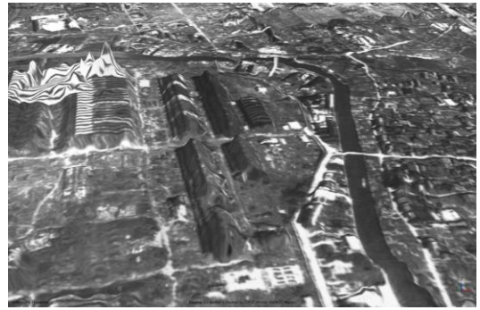
図-4 アナログ写真にもとづいた SfM 解析の結果得られたオルソモザイク画像 (特徴的な建物部を拡大)
