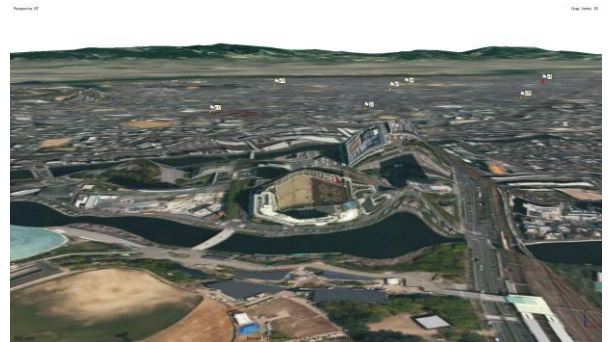
図-5 デジタル写真にもとづいた SfM 解析の結果得られたオルソモザイク画像 (特徴的な地物を拡大)
