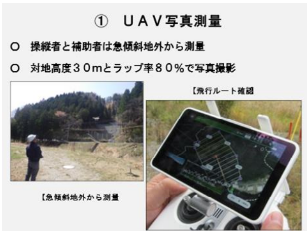
図-3 UAV写真測量状況
