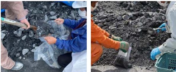
写真-3 試料 (左) ・処理土 (右) の外観と採取状況
