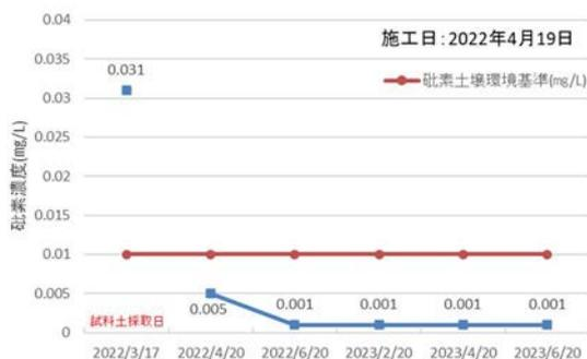
図-3 砒素の溶出量試験 (環境省告示第 18 号) 結果
