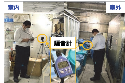
図8 騒音の計測状況 (騒音の測定高さ 1.2m)
