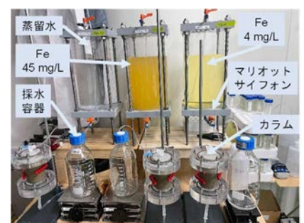
図-1 透水試験の様子
