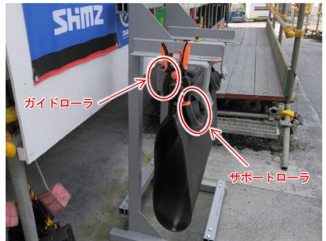
図-2 密閉式吊下げ型コンベヤ構造
