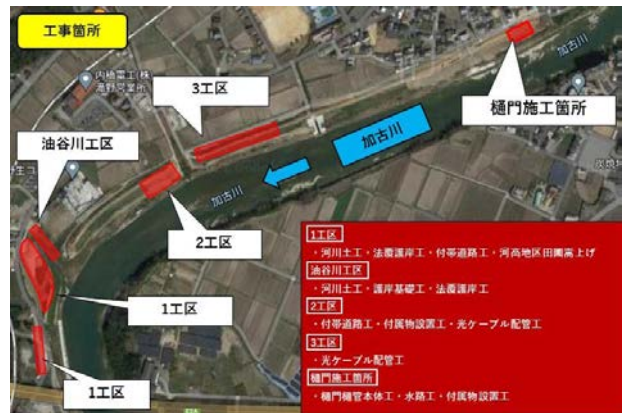
図-2 対象工事の工事概要
