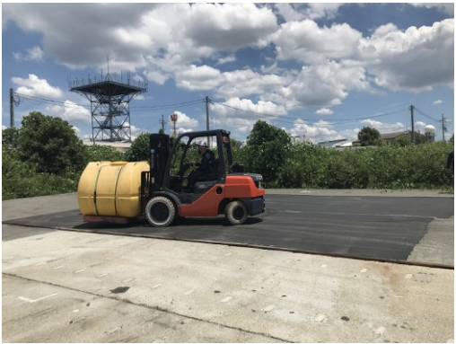
図-11 フォークリフト走行試験状況
