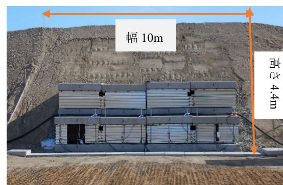
写真-1 土のう構造体の様子
