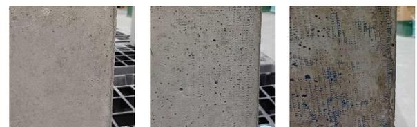
写真2 コンクリート板の表面
