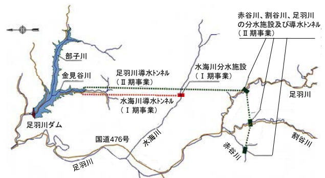
図-2 足羽川ダム計画平面図
