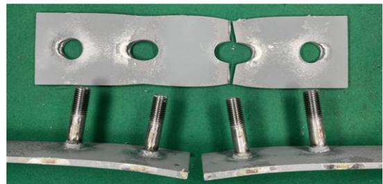
図-5 試験終了後の試験体の変形状(N1-A)
