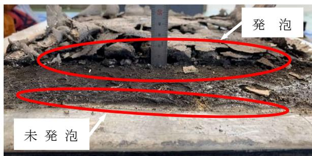
写真-1 加熱後の耐火塗料断面(供試体 C)
