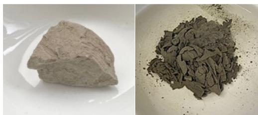
図 1 スレーキングによる試料状態の変化：試験前(左)、3 回の乾湿サイクル後(右)
