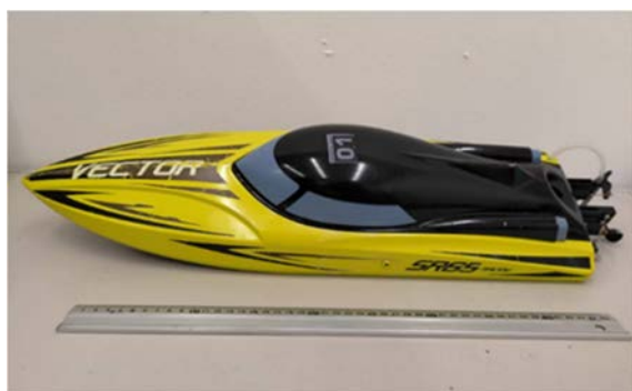
図-2 自律移動型浮子の外観
