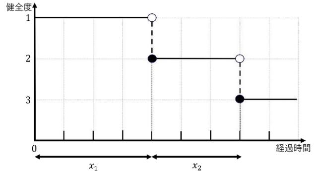
図-1 離散時間モデル
