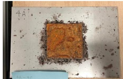
図-1 腐食鋼板
