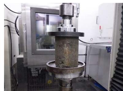
写真-3 一軸圧縮試験状況
