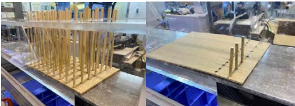
図-4 植生模型(左が9×7本植生、右が3本植生)
