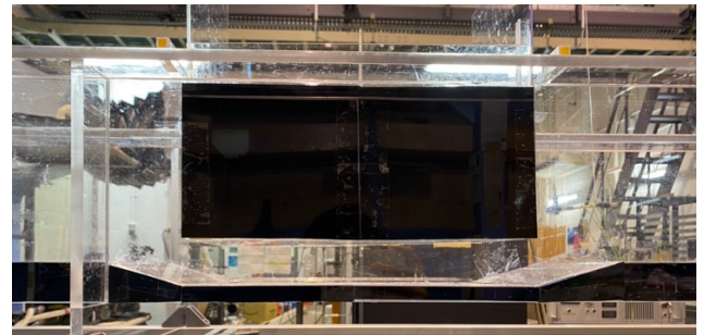
図-2 実験水路の逆サイフォン部
