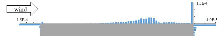
図3  $B/D = 6$  矩形断面の  $Stk = 0.0822$  (40  $\mu\text{m}$ ) 粒子の部位別付着割合
