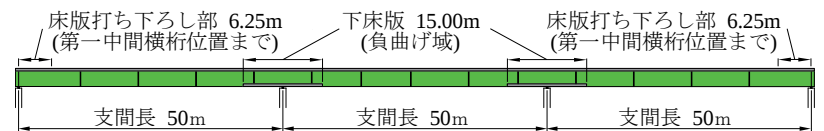
図-1 対象橋梁の側面
