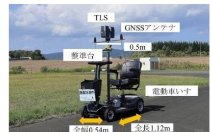
図-1 計測システム
