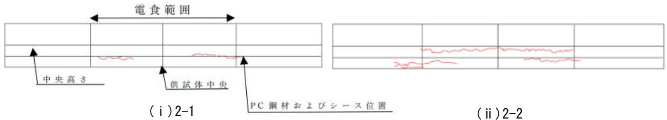
図2 腐食ひび割れ図
