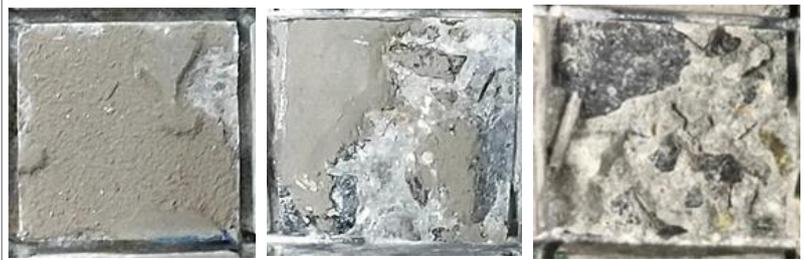
(a) 凝集破壊 (b) 凝集破壊と母材破壊 (c) 母材破壊
