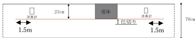
図3 堤体設置時の実験水路平面図
