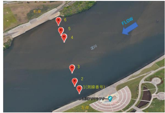
図-4 ドローン浮子軌跡(計測区間抜粋)
