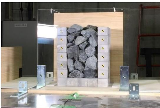
図1 作成した石橋断面モデル
