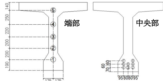
図 4 PC 鋼材(8-12φ5)[断面図](mm)
