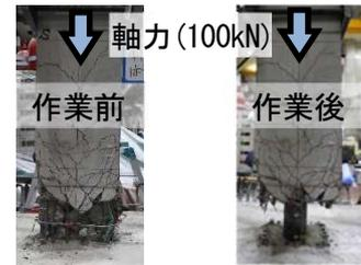
図-6 鋼管拘束コンクリート柱による自重支持
