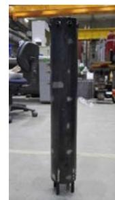
図-2 コンクリート拘束鋼管
