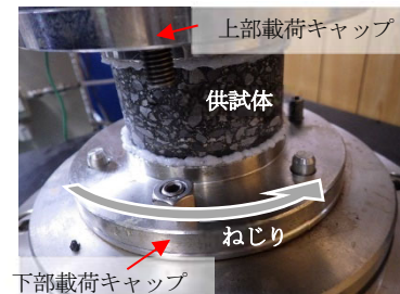
写真-1 繰返しねじりせん断試験
