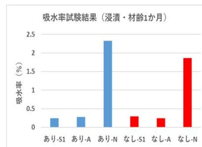
図-4 吸水率試験結果 (浸漬・1か月)
