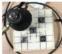
図-2 引張接着試験
