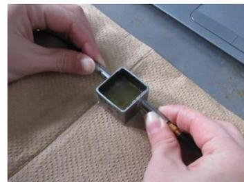
図-2 超音波伝播速度の計測の様子
