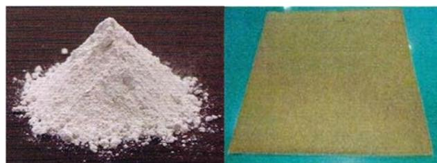
写真-1 Ca/Mg系複合材料(左)及び吸着シート(右)の外観
