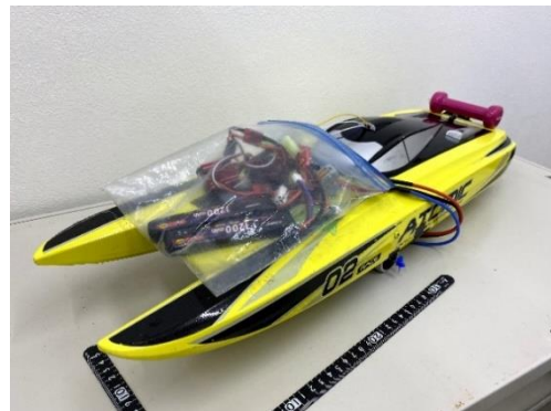
図-1 ロボットの試作機(全長 70cm, 横幅 20cm, 高さ 15cm)
